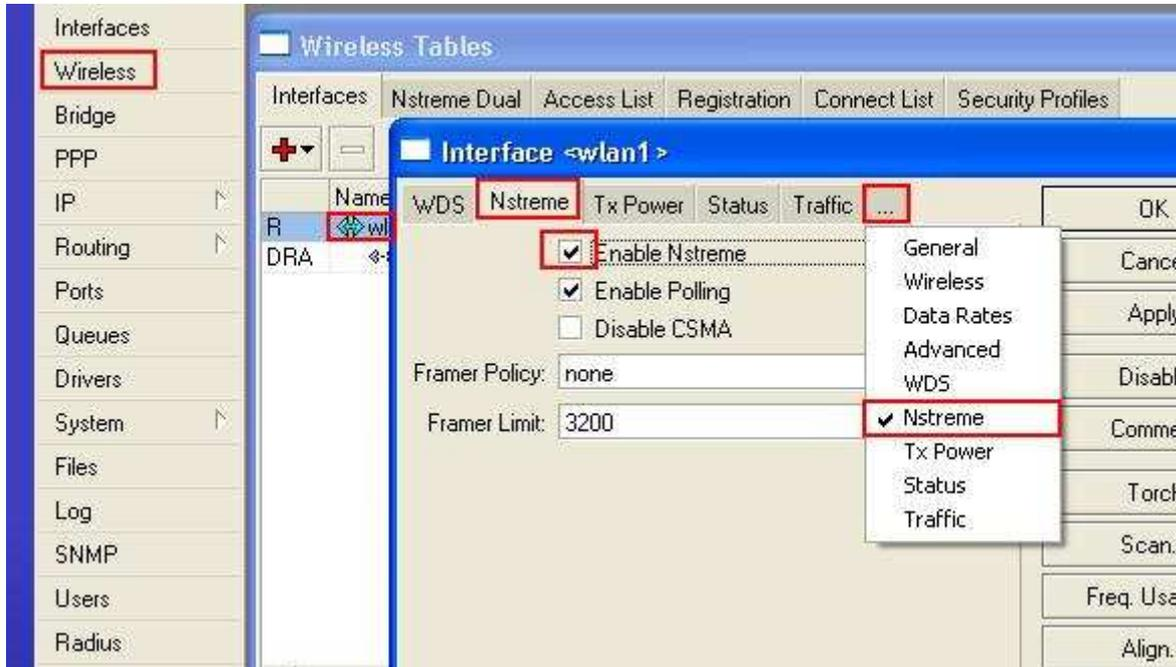
Falls Sie nun noch in der 5 GHz Frequenzbandbreite arbeiten können Sie noch den Turbo-Modus aktivieren, d.h. die Bandbreite wird von 20 MHz auf 40 MHz erhöht, jedoch haben Sie nun auch weniger Frequenzen zur Auswahl. Hier ist dann noch die erlaubten Frequenzen für den Outdoor-Bereich zu beachten. Dies ist von Land zu Land unterschiedlich, d.h. Sie müssen sich dann selbst informieren was Sie verwenden dürfen.
